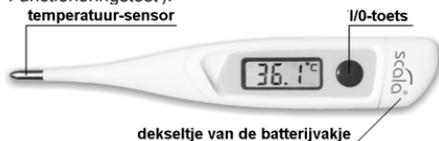
Vervolgens verschijnt indien de temperatuur van de sensor minder dan 32° C is een 'L' en '°C'. Na ca. 1 seconde begint '°C' te knipperen. De 'L' staat voor low (laag – lager dan 32° C). Tijdens het meten wordt de actuele temperatuur doorlopend getoond en '°C' knippert gedurende de gehele meettijd. Na ca. 10 seconden is de meting verricht.
