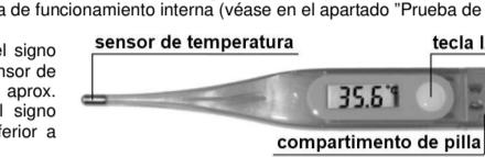
A continuación aparecerá una "L" y el signo "°C" si la temperatura aplicada al sensor de temperatura es inferior a -32 °C. Tras aprox. 1 segundo empieza a parpadear el signo "L". La "L" significa low (baja) - inferior a -32 °C.
