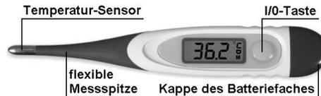
Während der Messung wird die aktuelle Temperatur laufend angezeigt und das „°C“ blinkt während der gesamten Messzeit. Nach ca. 10 Sekunden ist die Messung abgeschlossen.
