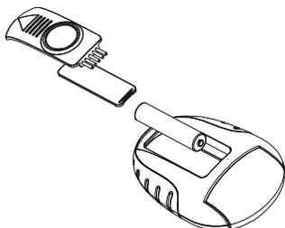
Per cambiare la batteria, rimuovere la spazzola con la lente. Dopodiché si potrà accedere al coperchio del vano della batteria. Cambiare la batteria esaurita.
