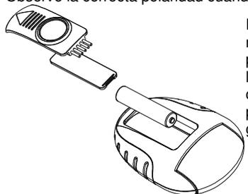
Para cambiar la pila, retire el cepillo con lupa para obtener acceso a la tapa del compartimento de la pila. Sustituya la pila gastada.
