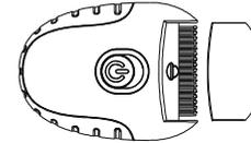
2. Deslice la tecla de funcionamiento a la posición de estado de funcionamiento/luz LED. El LED verde debe lucir. De no ser éste el caso, se debe cambiar la pila (véase página 5).
